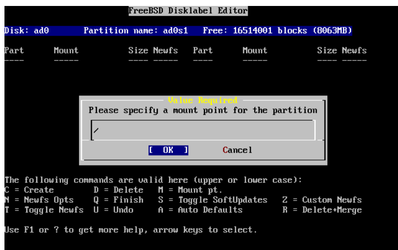
Figure 2.23. Choisir le point de montage de la partition racine
